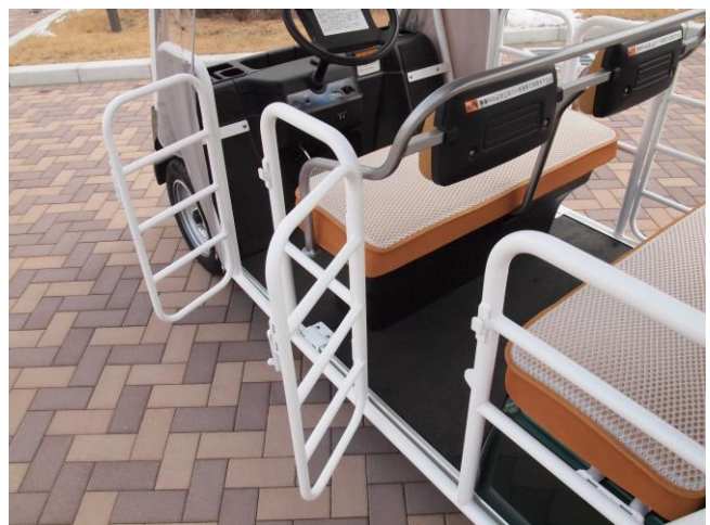
落下防止用の手すりを装備
